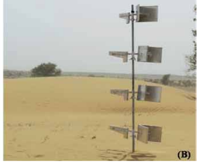
चित्र 8.10 हवा कटाव अध्ययन के लिये स्वचालित मौसम स्टेशन (अ) हवा कटाव पारखी स्टेशन (ब) Fig. 8.10 Automatic weather station (A) and wind erosion sampler (B) for wind erosion study
