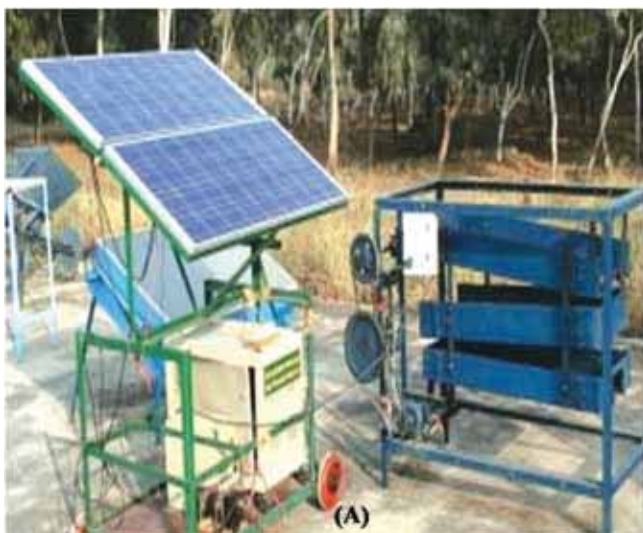
चित्र 8.2 हाइब्रिड बेर ग्रेडर पीवी मोबाइल यूनिट के साथ (अ) ग्रेडेड बेर (ब) Fig. 8.2 Hybrid ber grader, operation with PV mobile unit (A) graded ber (B)
