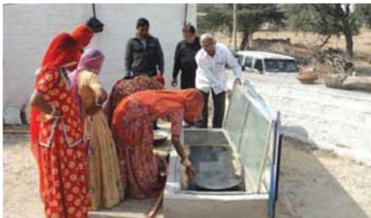
चित्र 10.3 पुरखावास गाँव में लगाये गए पशु आहार सौर कुकर Fig. 10.3 Animal feed solar cooker installed at village Purkhawas
