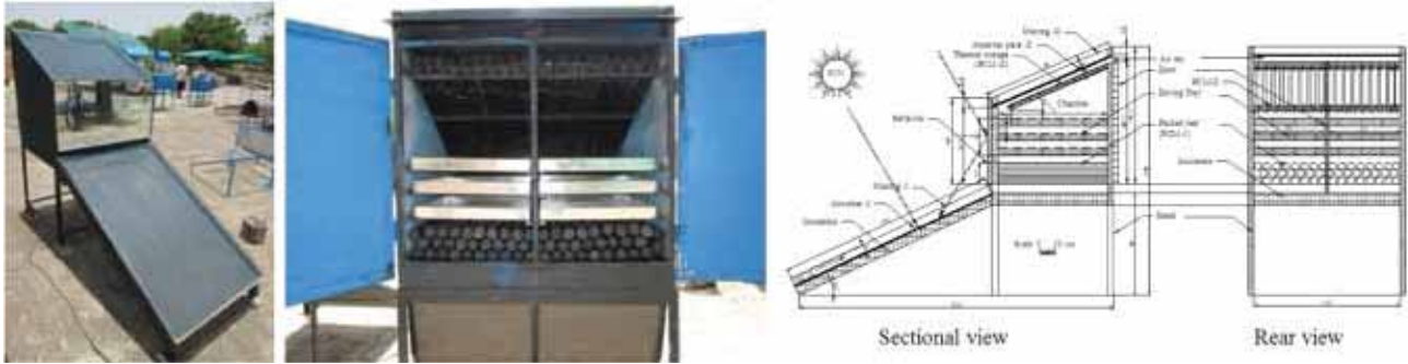
चित्र 8.7 सौर ऊष्मा भण्डारण के साथ समतल अवशोषक वाले शुष्कक का प्राकृतिक संवहनी के साथ योजनाबद्ध आरेख Fig. 8.7 Flat plate absorber with PCM-TES solar crop dryer with schematic view
