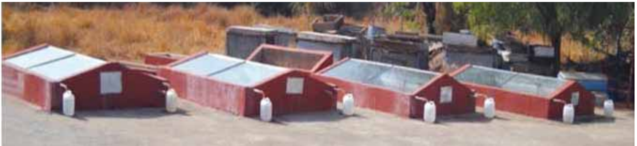
चित्र 8.4 विभिन्न पदार्थों से बने सौर अलवणीकरण सयंत्र Fig. 8.4 Solar desalination devices made of different materials
