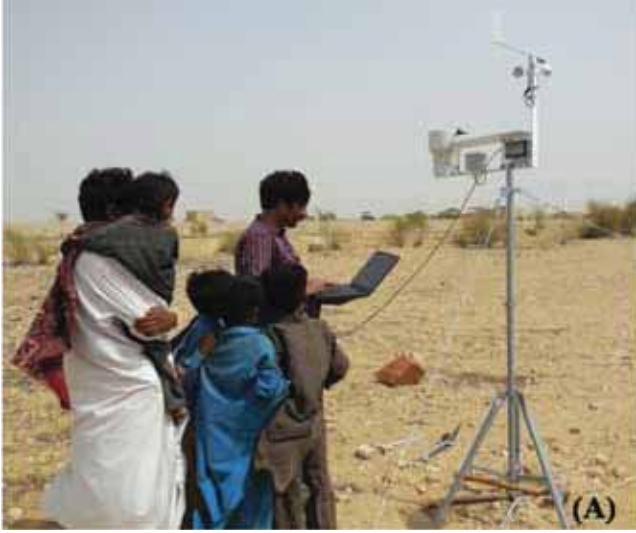
चित्र 8.10 हवा कटाव अध्ययन के लिये स्वचालित मौसम स्टेशन (अ) हवा कटाव पारखी स्टेशन (ब) Fig. 8.10 Automatic weather station (A) and wind erosion sampler (B) for wind erosion study
