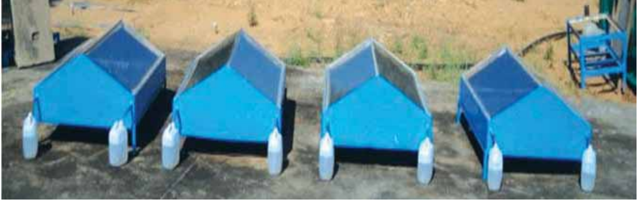
चित्र 8.3 धात्विक सौर अलवणीकरण उपकरण Fig. 8.3 Metallic solar desalination devices
