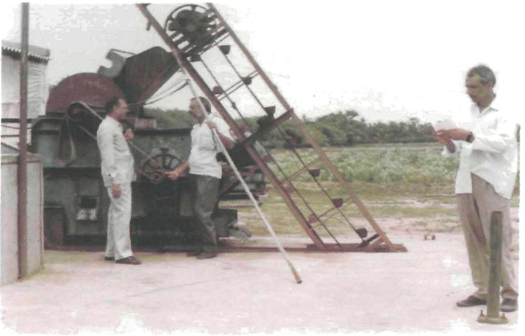
चित्र 31. विलायती बबूल की फलियों को साफ करने हेतु थ्रेसिंग मशीन।
