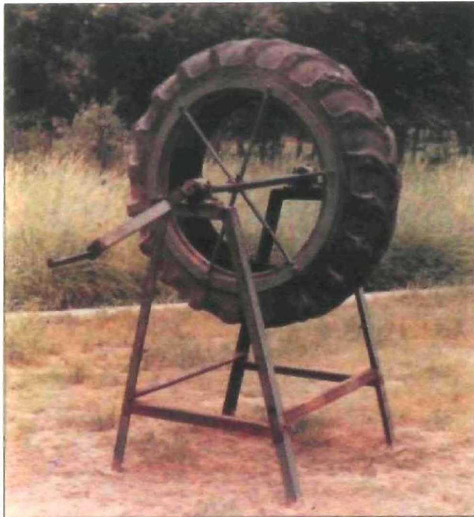
चित्र 4. काजरी द्वारा विकसित चारे के बीज की गोलियां बनाने की मशीन
